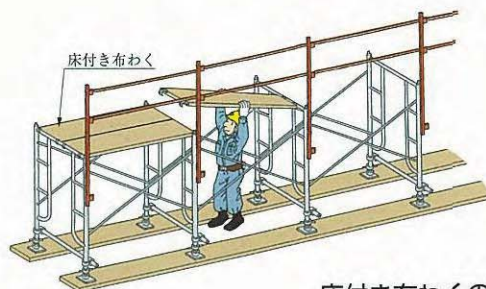
床付き布わくの取付け
