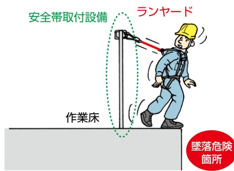
可能な限り、高い位置にランヤードを取り付ける等、墜落阻止時に発生する衝撃を低減させる。
