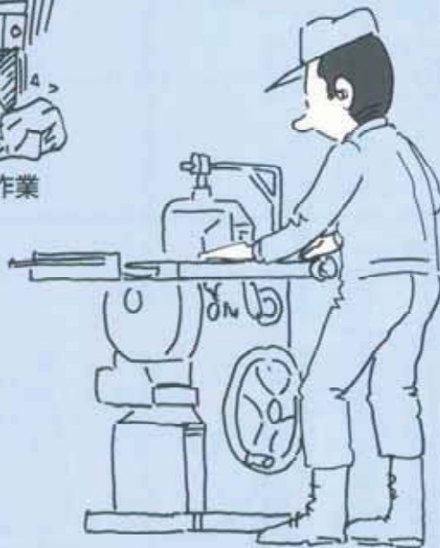
丸のこ盤を用いた切断作業
