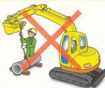
ドラグ・ショベルにより土止め用矢板等をつり上げる場合は、つり上げる荷重を標準荷重以下、かつ1トン未満とし、負荷させる荷重に応じた強度を有するフック等を使用すること。
